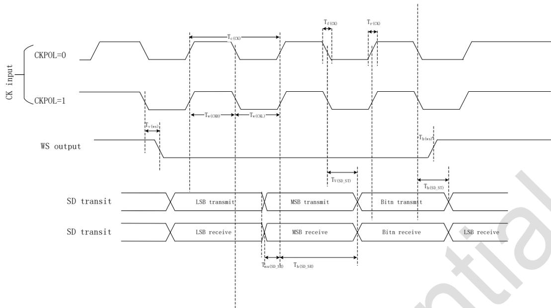
图 5-7 I<sup>2</sup>S 时序图 – 主机模式 (Philips 协议)
