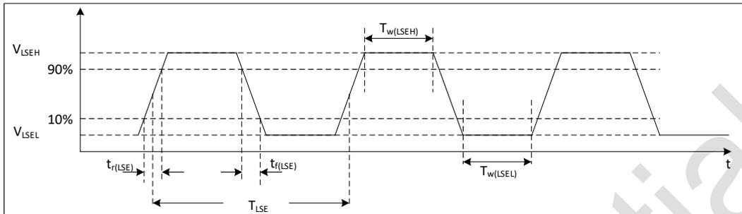
图 5-3 外部低速时钟时序图
