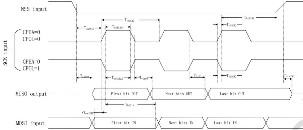
图 5-4 SPI 时序图 – 从机模式, CPHA = 0
